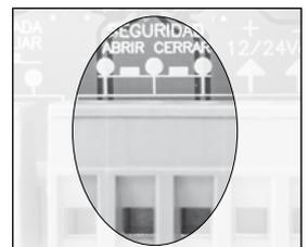
**Si no instala ningún accesorio, debe puentear los bornes.** Si durante la maniobra de cierre se activase el sistema de seguridad, la maniobra se detendrá y tras unos segundos de espera se realizará la maniobra de apertura.
