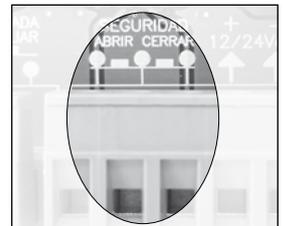
**Si no instala ningún accesorio, se deben puentear los bornes.** Si durante la maniobra de apertura se activase el sistema de seguridad, la maniobra se detendrá, realizando la maniobra de cierre durante 30 cm para poder liberar un posible obstáculo atrapado.
